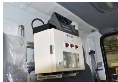
運転席の計量ボックスと プリンター付表示機
