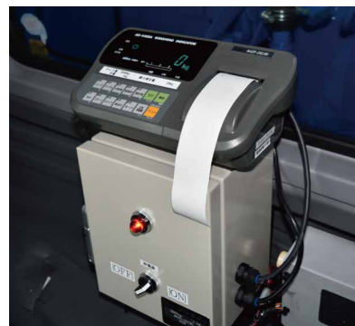
運転席の計量ボックスと プリンター付表示機
